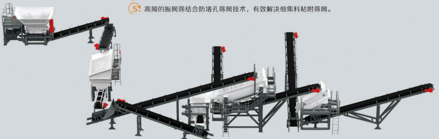
RPS100型RAP辊式破碎筛分设备是福建铁拓机械有限公司根据自身多年来对沥青厂拌热再生设备的设计经验，结合国内RAP物料获取方式的特殊性而推出的一款全新的专用破碎筛分产品。
